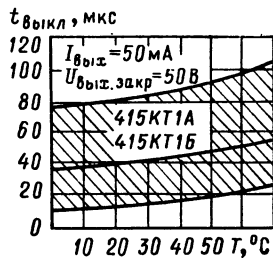
Рис. 12.20. Зависимость времени выключения от температуры (указана зона разброса)
